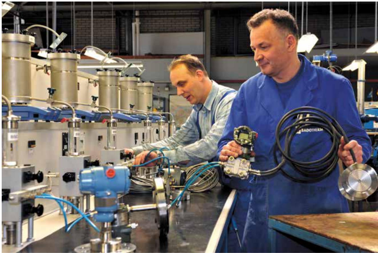
De scheidingsmembranen, gemonteerd op een druktransmitter, worden onder hoog vacuüm gevuld met een specifieke vulvloeistof
